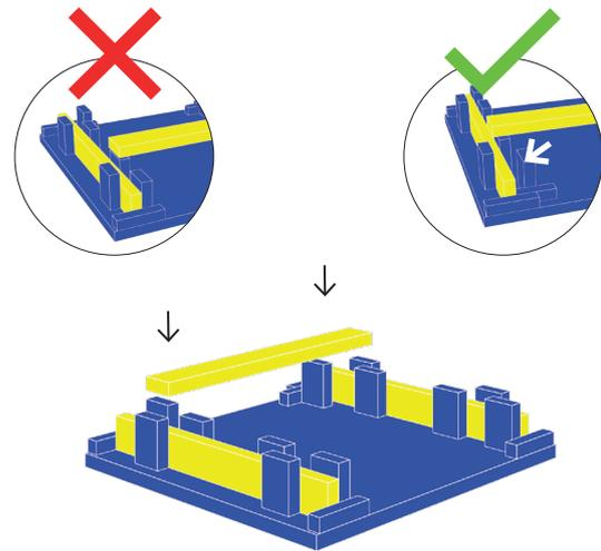
10 Schritt 5-8 wiederholen, jedoch wird nun nur eine lange Zarge montiert. Die lange Zarge muss an der richtigen Position montiert werden!
