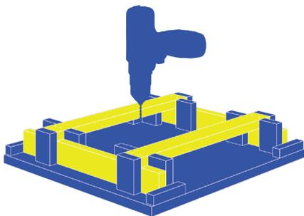
7 Durch die bereits vorgebohrten Löcher der langen Zargen die Beine mit einem 3-mm Bohrer vorbohren.
