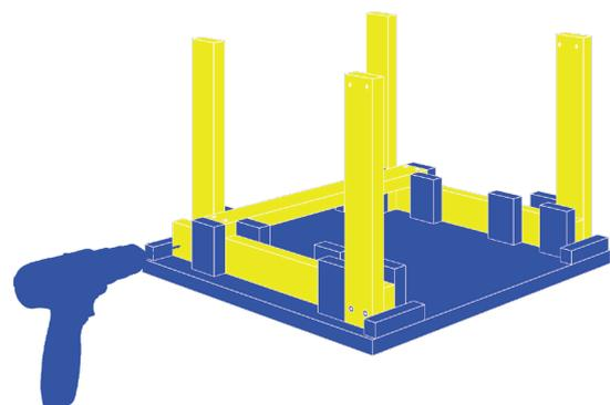
12 Die zwei nicht vorgebohrten kurzen Zargen auf der Innenseite positionieren. Dann durch die Beine von außen mit einem 3-mm Bohrer zwei Schraubenlöcher vorbohren. Dabei darauf achten, dass auch die kurze Zarge vorgebohrt wird.
