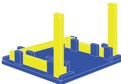
11 Die beiden vorgebohrten kurzen Zargen positionieren und wie in Schritt 7 mit einem 3-mm Bohrer vorbohren und anschließend wie in Schritt 8 verschrauben.
